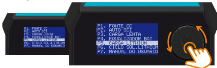
Após confirmar a seleção da função, a fonte irá exibir a tela abaixo com os últimos valores configurados. Para realizar os ajustes, girar o encoder até que a opção desejada esteja destacada e clicar no encoder para ajustar. Após selecionado o valor, basta clicar no encoder para confirmar.
