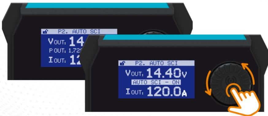
Esse modo é ideal para o sistema de som automotivo pois quando o som não está sendo utilizado, a potência da fonte é utilizada para realizar uma recarga rápida no banco de baterias, reduzindo a tensão automaticamente quando essa não for mais necessária. Quando o som é utilizado a tensão sobe automaticamente para suprir a demanda e dar mais potência ao sistema de som.
