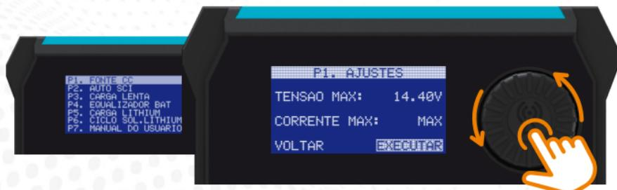
Poderão ser selecionados valores de corrente com variação entre o valor máximo da fonte e o mínimo de 5A. Ao selecionar a opção MAX, o controle de corrente passa a ser totalmente desativado e a fonte fornecerá a máxima capacidade de corrente sempre que esta for solicitada pela carga.
