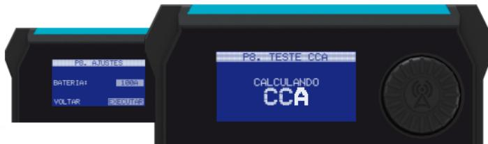
Após 10 segundos, o display exibe a tela abaixo, com o valor de CCA obtido na leitura, que pode variar entre 20A e 10000A, e o valor de Ri (resistência interna da bateria) em mΩ. Também exibe um valor de porcentagem comparativo, do valor obtido com o valor de uma bateria de chumbo ácido nova (valores padrão salvos na memória interna), após finalizado o teste de CCA a fonte retorna automaticamente para o último programa utilizado.
