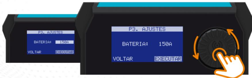
Caso não deseje alterar nenhum valor, basta clicar em executar ou aguardar sem realizar nenhuma alteração e a fonte irá iniciar o procedimento de carga com os valores previamente configurados.
