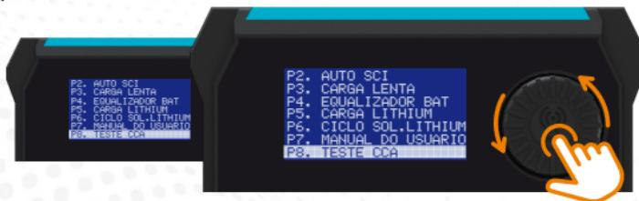
Após confirmar a seleção da função, a fonte irá exibir a tela abaixo e exibir o último valor do banco de baterias configurado.
