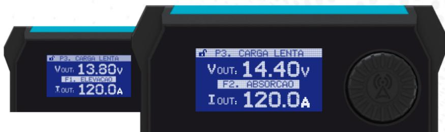
Na fase de **FLUTUAÇÃO** a tela abaixo será exibida. Ao final do processo de carga ocorre a redução automática da tensão para 13,8V com pulsos de 14,4V a cada 5 minutos (flutuação automática + sistema de carga inteligente integrado). Durante esse processo, a carga da bateria é mantida e ela é carregada com sua máxima capacidade sem aquecimento, pois a carga durante esse processo é feita de forma pulsativa.
