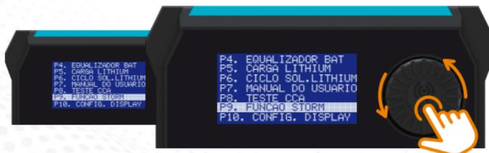
Ao ser acionada, o display mostra a tela abaixo, com a inscrição FUNÇÃO STORM – ON. Nesse momento as ventoinhas irão acelerar e a tensão de saída irá ser reajustada automaticamente para 15,4V por 30 segundos.
