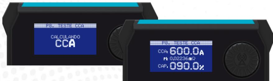
Essa função pode ser usada para testar um banco de baterias que esteja dentro das especificações máximas da fonte (para ligação em paralelo, somar o CCA de cada bateria) porém, é mais indicada para o teste de baterias individuais.
