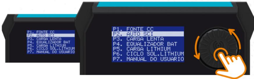
Após confirmar a seleção da função, a tensão de saída é configurada automaticamente para 13,8V e a fonte começa a monitorar a potência de saída solicitada. Não é necessário realizar nenhuma configuração nesse modo. A fonte iniciará automaticamente o modo Auto SCI e a tela abaixo (à esquerda) será exibida. Sempre que a função SCI estiver ativa, a tela abaixo (à direita) será exibida.
