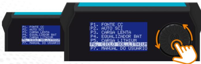
Após confirmar a seleção da função, a fonte irá exibir a tela abaixo, com os últimos valores configurados. Para realizar os ajustes desejados, girar o encoder até que a função seja destacada e clicar no encoder para ajustar. Após ajustado o valor, basta clicar no encoder para confirmar.
