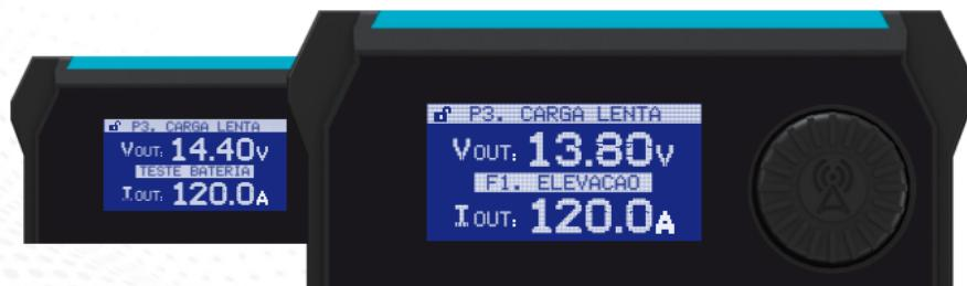
Durante o processo de **ABSORÇÃO** a tela abaixo será exibida. Nessa fase a tensão ficará fixa em 14,4V até que a corrente atinja 3% da corrente do banco configurado, permitindo que a fonte absorva o máximo de carga, mudando automaticamente para a fase de flutuação quando isso ocorrer. Essa fase não tem tempo definido, levando o tempo necessário para que a bateria atinja o valor correto de corrente.
