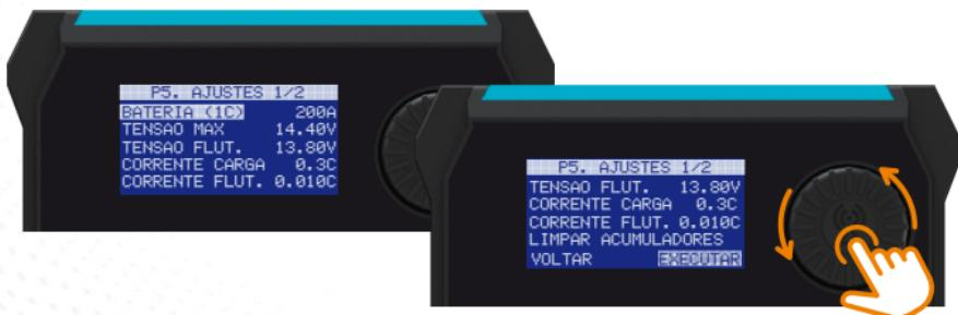
Quando a função CARGA LITHIUM é ativada, a Fonte STORM LITHIUM exibe a tela abaixo, reduz sua tensão de saída, e se ajusta automaticamente, tomando como base os parâmetros de tensão e corrente máximos ajustados.
