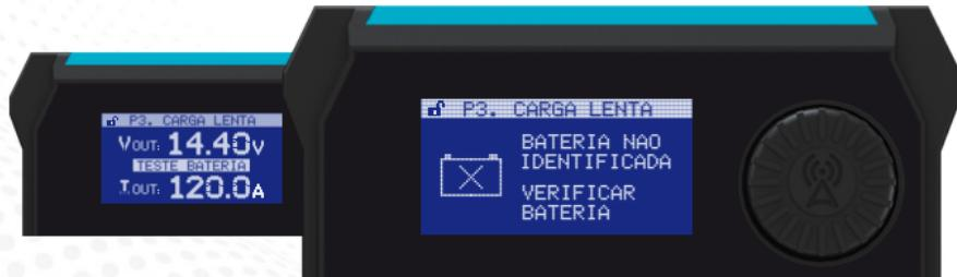
Caso o procedimento não seja realizado e as configurações de banco estejam corretas, pode indicar o final da vida útil da bateria. Para a fonte STORM LITHIUM executar o modo carga lenta corretamente é necessário configurar o banco de baterias utilizado. Durante a seleção, caso sua bateria não se enquadre nas opções
