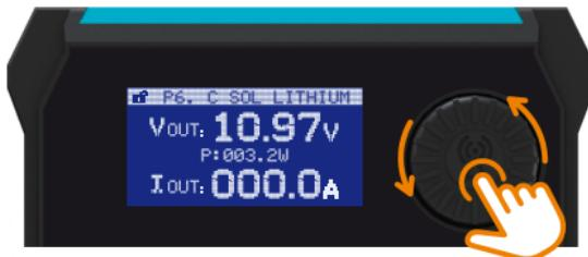
Caso não deseje alterar nenhum valor, basta clicar em executar ou aguardar sem realizar nenhuma alteração e a fonte irá iniciar o procedimento de carga com os valores previamente configurados.
