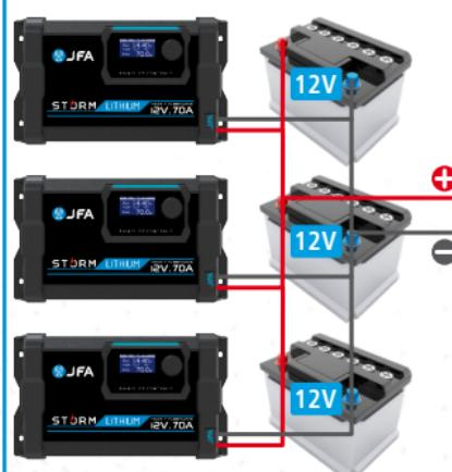
Em ligações em série para o sistema high voltage, é recomendado ligar todas as baterias numa configuração paralela por 24 horas, antes de se fazer a ligação em série. Este procedimento ajuda a equalizar todas as baterias e compensar a diferença de estado de carga entre elas em função da data de fabricação ou condições de armazenamento.
