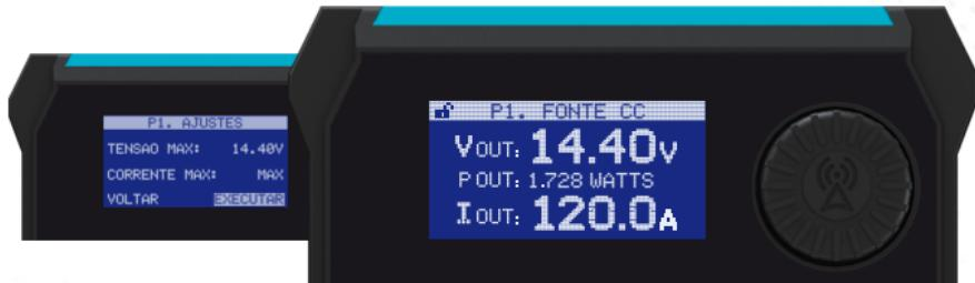
Caso não deseje alterar nenhum valor, basta clicar em executar ou aguardar sem realizar nenhuma alteração e a fonte irá iniciar o procedimento de carga com os valores previamente configurados.
