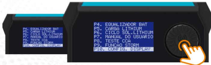
Após confirmar a seleção da função, a fonte irá exibir a tela abaixo, com os últimos valores configurados. Para selecionar os ajustes, girar o encoder até que o valor seja destacado. Para realizar os ajustes, girar o encoder até que o valor seja obtido e, após selecionado o valor, basta clicar no encoder para confirmar e retornar.
