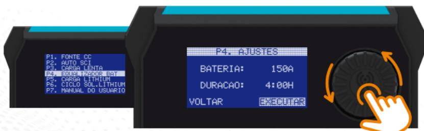
Após configurar o valor do banco e o tempo de atuação da função, a fonte iniciará automaticamente o processo de carga, caso não deseje alterar nenhum valor, basta clicar em executar ou aguardar sem realizar nenhuma alteração e a fonte irá iniciar o procedimento de carga com os valores previamente configurados
