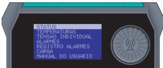
Para selecionar as opções basta girar o botão no sentido anti-horário e clicar para entrar. As opções de seleção são: Temperatura, Tensão individual das células, Alarmes, Registro Alarmes, Carga, Manual do usuário e configuração do display.
