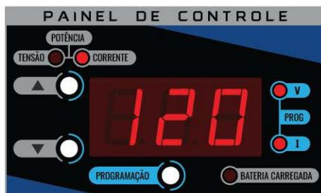
Após configurar os valores de tensão e de corrente de saída, a fonte iniciará automaticamente o procedimento de controle da saída, apagando os leds **PROG** e exibido a tensão/corrente instantâneos do banco. Caso não deseje alterar nenhum valor, basta aguardar sem realizar nenhuma alteração e a fonte irá iniciar o procedimento de carga com os valores previamente configurados.
