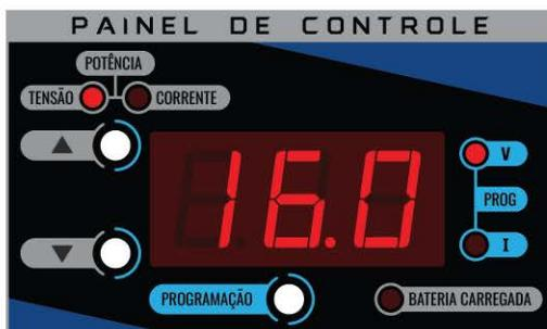
Após configurar o valor da tensão de saída em 16,0Vdc, aguardar 5 segundos. A fonte irá exibir a mensagem **I.out** e exibir o último valor de corrente de saída configurado.
