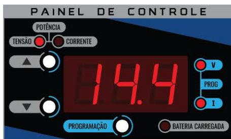
Após configurar o valor da tensão de saída e aguardar 5 segundos, a fonte irá exibir a mensagem **I.out** e exibir o último valor de corrente de saída configurado. Nesse momento, utilizar as chaves a esquerda do painel (**SETAS**) para selecionar o valor desejado.
