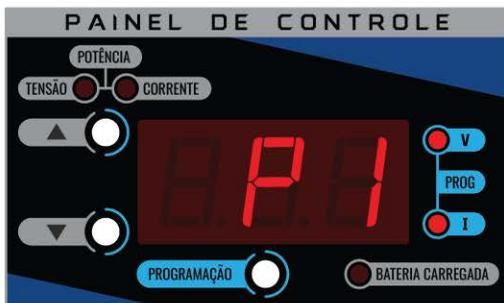
Após aguardar 2 segundos, a fonte irá exibir a mensagem **V.out** e exibir o último valor da tensão da saída configurado.
