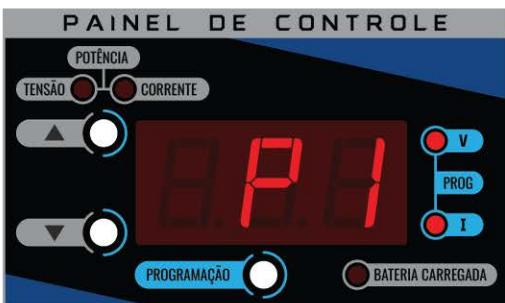
Após aguardar 2 segundos, a fonte irá exibir a mensagem **V.out** e exibir o último valor da tensão da saída configurado. Nesse momento, utilizar as chaves a esquerda do painel (**SETAS**) para selecionar o valor desejado.
