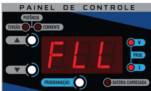
**ATENÇÃO:** Ao utilizar a fonte para o carregamento personalizado do banco de baterias, a fonte **NÃO** entrará no modo flutuação de forma automática.
