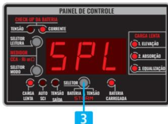
Para desativar a função, antes do tempo acabar, basta pressionar novamente a chave **SELETOR BATERIA/TENSÃO/STORM** enquanto a função estiver sendo executada. O display exibe a inscrição **OFF** e a fonte retorna à sua condição de funcionamento anterior.
