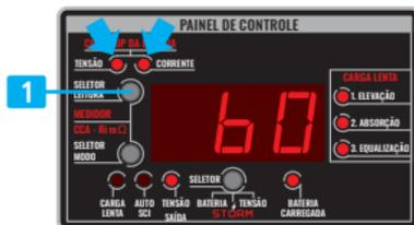
Conecte a bateria ao carregador e aguarde a luz de indicação **BATERIA CARREGADA** acender (o tempo de carga pode variar dependendo da capacidade da bateria e da fonte utilizada). Leia no display a quantidade de amperes que a bateria acumulou durante o processo de carga.
