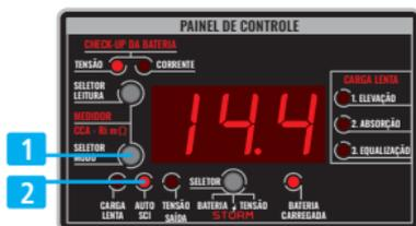
O **AUTO SCI** permite que a bateria absorva maior quantidade de carga e impeça a elevação excessiva do potencial das placas, fenômeno químico causado pelo estresse de carga (eletrólise), aumentando a vida útil e a eficiência das baterias.
