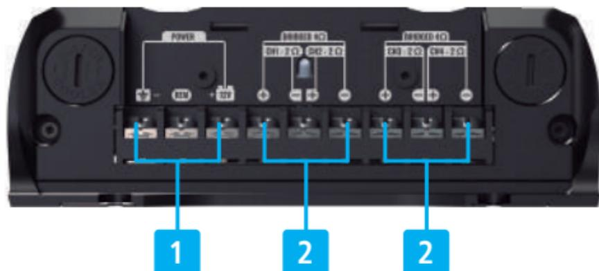
**1 Conexão de alimentação:** Conectar o terminal positivo (+) diretamente ao polo positivo das baterias e o terminal negativo (-) diretamente ao polo negativo da bateria. O terminal REM é utilizado para comando remoto e deve ser conectado à saída REMOTE do player. Utilizar preferencialmente terminais tipo forquilha garfo para conexão nos modelos de 380W e terminal tubular na conexão dos modelos de 800W.
