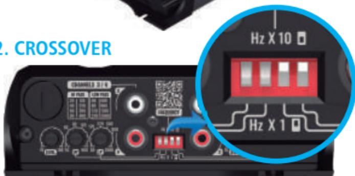
Com o auxílio do **Seletor de ajuste do crossover**, mostrado acima, é possível definir os pontos de corte dos filtros de maneira muito mais completa, personalizando a saída de áudio. O ajuste dos filtros (**HP e LP**) deve ser feito considerando a resposta em frequência dos alto-falantes utilizados, pois muitos deles são sensíveis a uma deflexão muito acentuada da membrana, causada pela utilização de faixas de frequência inferiores a indicada.
